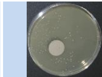
Surface après nettoyage avec le nettoyant enzymatique : réduction très significative du nombre de colonies de microorganismes
