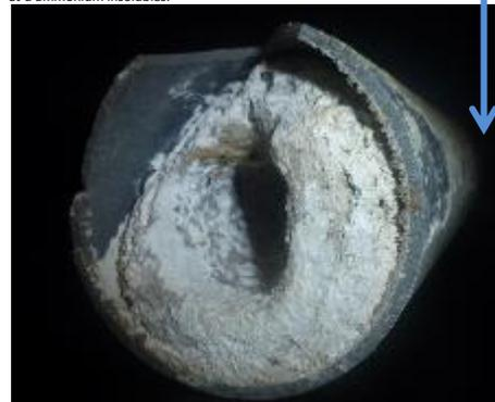
En libérant progressivement des microorganismes épurateurs les blocs de bionettoyants, URIBIO 72 empêche la cristallisation des sels d'urée totalement insolubles. L'obstruction nécessite le remplacement coûteux des tuyauteries d'évacuation
