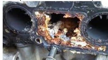
Résultat d'une mauvaise protection : corrosion, obstruction, diminution performance de l'échange thermique
