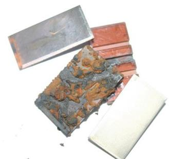
Corrosion très nette des métaux constituant les circuits (perte de poids et percement possible à courte échéance)
